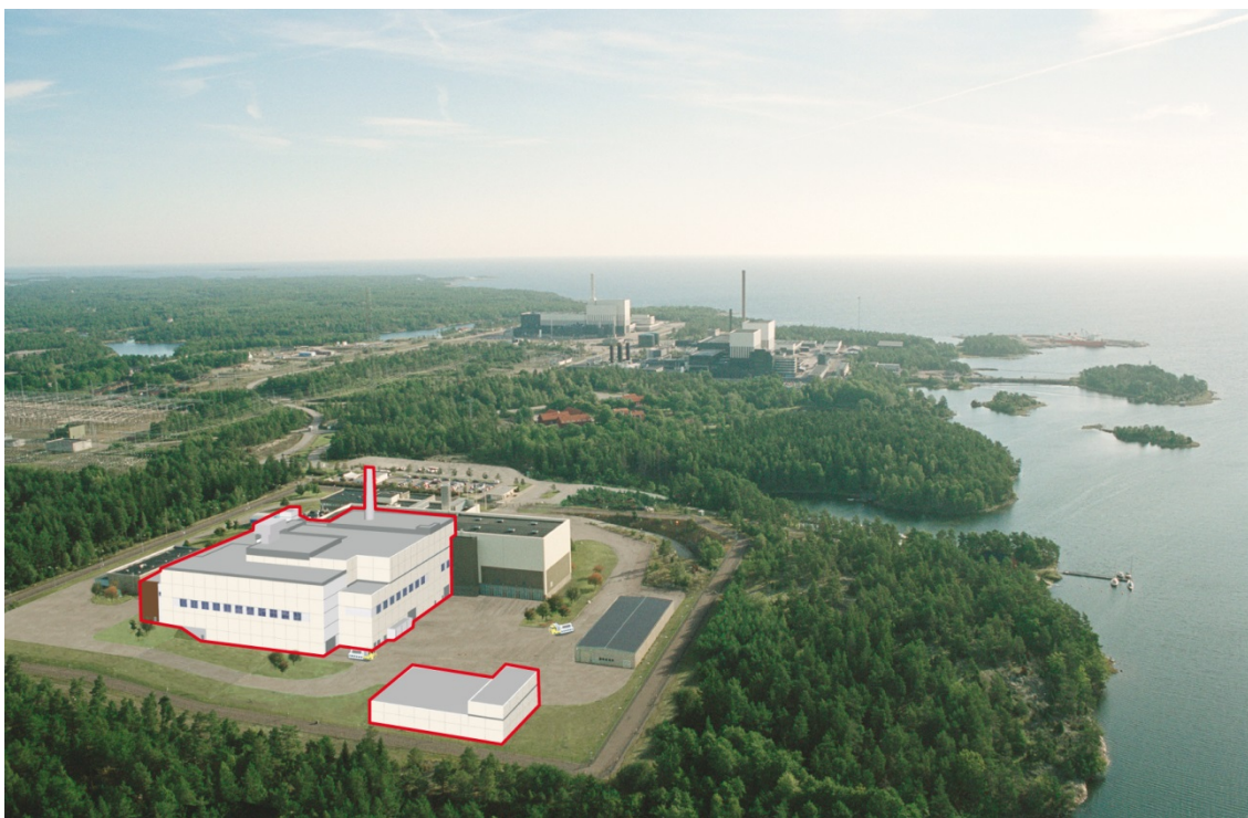
Рисунок S -6. Заводской блок для капсулирования будет расположен в непосредственной близости от Clab, и обе эти установки начнут работать как единый интегрированный комплекс под названием Clink. Красным отмечено то, что является фотомонтажом.
