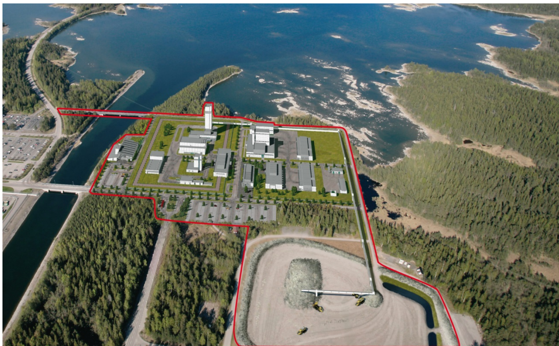
Рис. S-7. Размещение могильника в Сёдервикене, Форсмарк (фотомонтаж). АЭС в Форсмарке видна слева на фотографии, а в самом низу показано скальное хранилище. Красным отмечено то, что является фотомонтажом.
